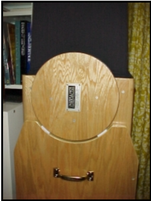
Bilde 1 : Altitude-hjulene i friksjonslagre. De hvite klossene i lageret er av teflon.
